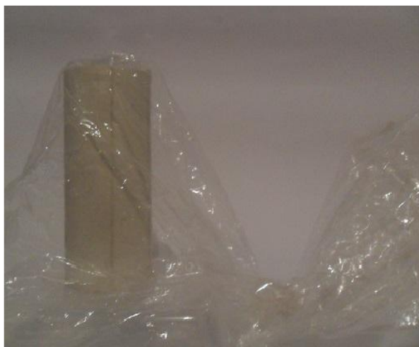
FIGURA 3.2. Corpo de prova ensacado
