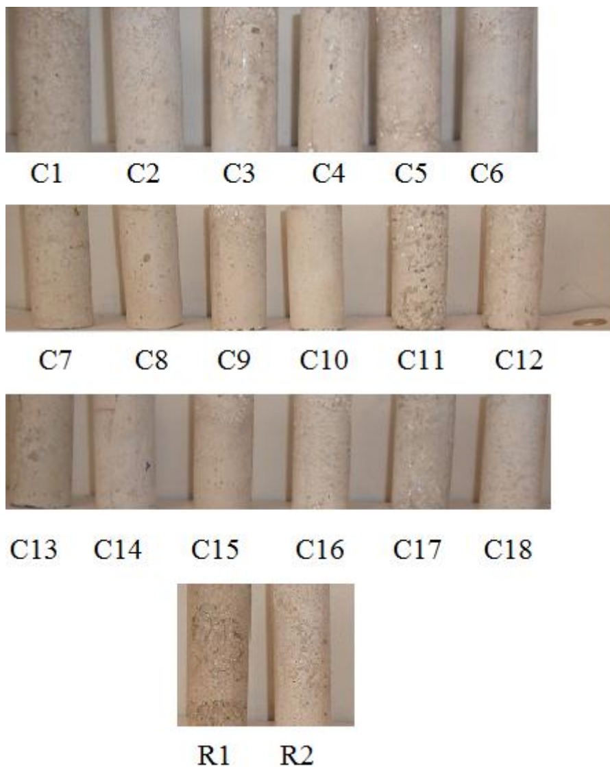
FIGURA 4.11. Compostos fabricados com cimento, isopor e água.
